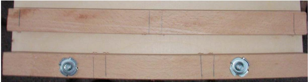
Hier sieht man die aufgezeichneten vier Bohrungen auf der Spannleiste (unten im Bild, bereits montiert) und die vier Bohrungen der Halteleiste (oben im Bild).
