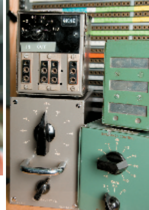
Ein Blick auf die Originale: In der grünen Box oben rechts befindet sich der Übertrager, der im RS127-Box-Plug-in hervorragend emuliert wird.
