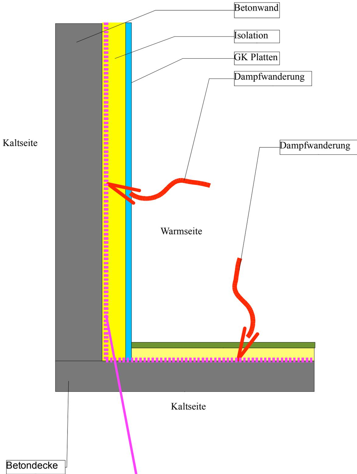
**Kondensat an Betonwand
