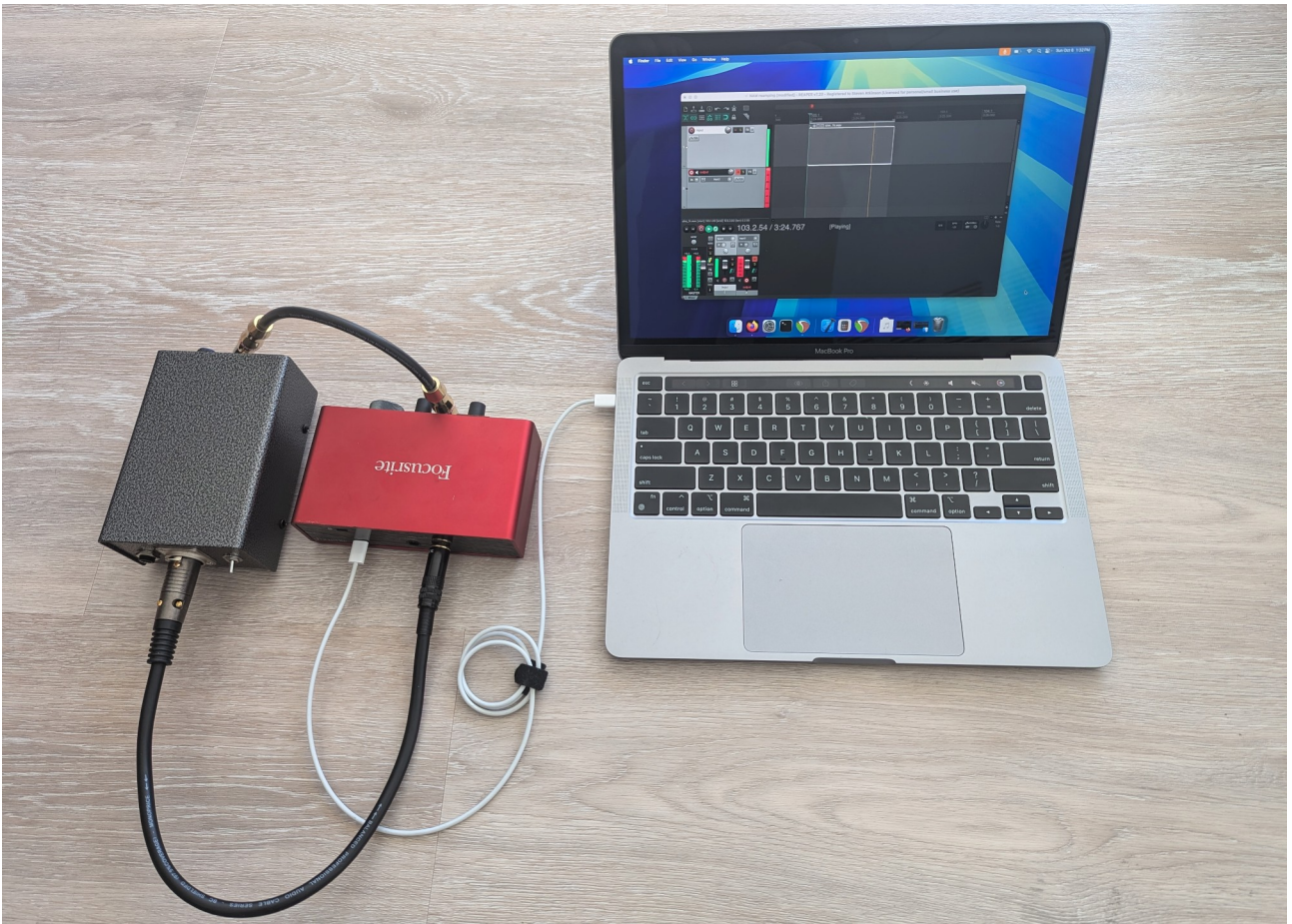
Abb. 28: Mein Reamping-Aufbau, der Send ist direkt an den Return angeschlossen
