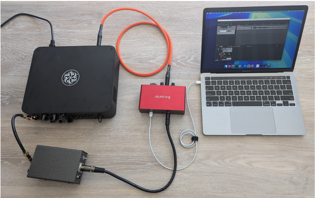
Abb. 26: Reamping Beispiel. Der Ausgang des Focusrite Solos ist über die Reamping-Box an den Eingang des Verstärkers angeschlossen. Der (Effekt Loop!) Send des Verstärkers wird an den Eingang des Interfaces zurückgeführt.
