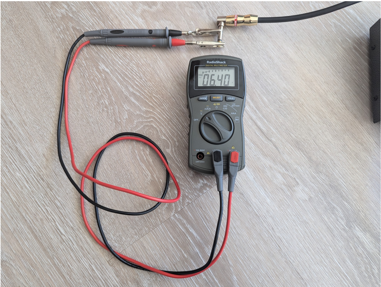
Abb. 27: Messung am Stecker, der an den Verstärkereingang angeschlossen war. Hier habe ich 6,4 V RMS gemessen.
